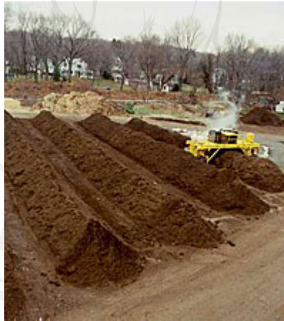
รูปที่ 2.5 การหมักแบบกองแถวพลิกกลับกอง
