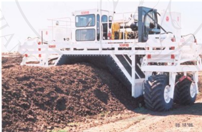
ข) การพลิกกลับกองด้วยเครื่องจักร
