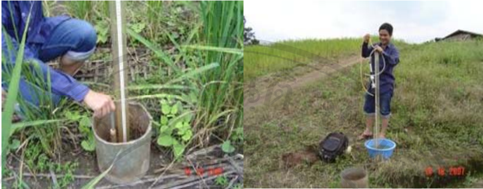
รูปที่ 3.4 แสดงการวัดอัตราการซึมน้ำเข้าสู่ผิวดิน (Infiltration Rate, IR) โดยใช้เครื่องมือสำเร็จรูป งานวัดการซึมน้ำของดิน (Disc Permeameter)
