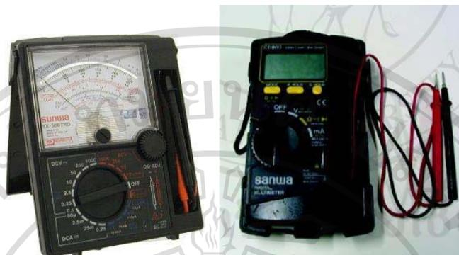
รูปที่ 3.2 เครื่องวัดแรงเคลื่อนไฟฟ้าและกระแสไฟฟ้า
