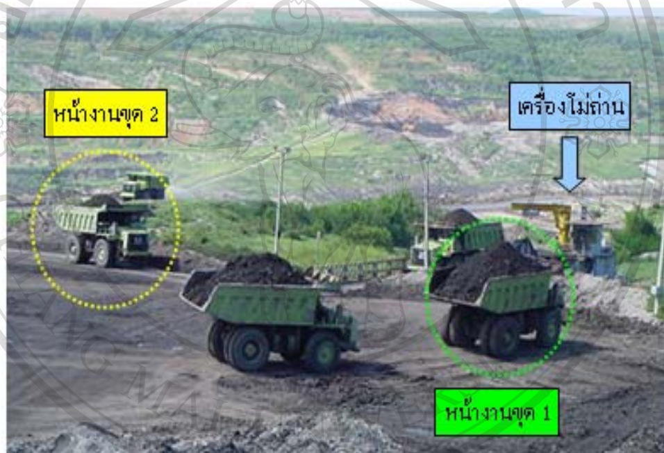
รูปที่ 4.22 การจัดลำดับการเทถ่านที่ขุดจากหน้างานก่อนเข้าเครื่องโม่ถ่าน
