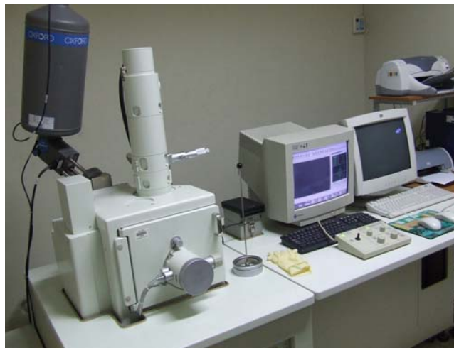
รูป 3.15 กล้องจุลทรรศน์อิเล็กตรอนแบบส่องกราดชนิด Low vacuum (JEOL JSM 5910LV)
