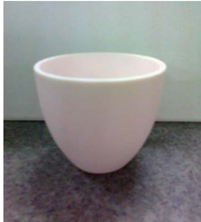
รูป 3.3 ถ้วยหลอมอะลูมินา ( \text{Al}_2\text{O}_3 crucible)
