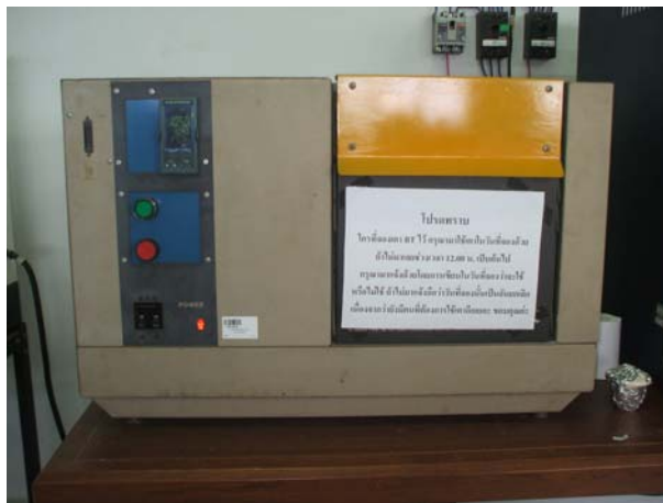
รูป 3.9 เตาเผาไฟฟ้าสำหรับเผาฉนวน
