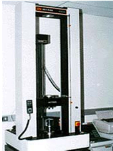
รูป 3.16 เครื่องมือทดสอบแบบอเนกประสงค์ [Universal testing machine (Instron Model 55R4502)]
