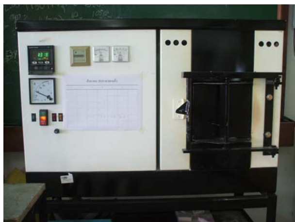
รูป 3.5 เตาเผาไฟฟ้า (furnace) สำหรับหลอมแก้ว
