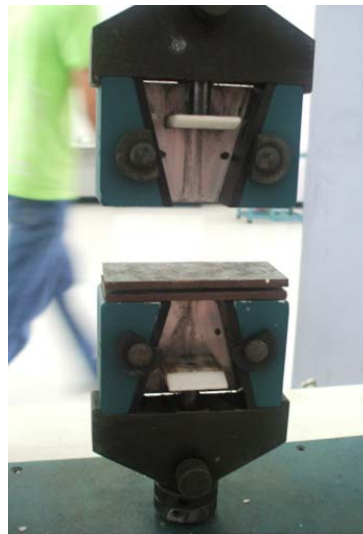
รูป 3.17 การติดตั้งชิ้นงานบนเครื่องมือทดสอบแบบอเนกประสงค์
