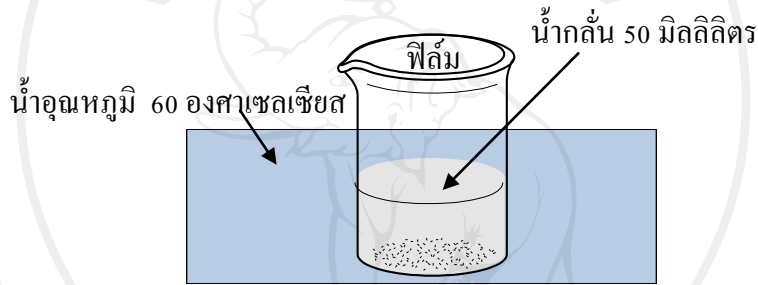
รูป 2.8 การจัดอุปกรณ์การทดสอบการต้านการเกิดฝ้าบนฟิล์มแบบวิธี hot fog test
