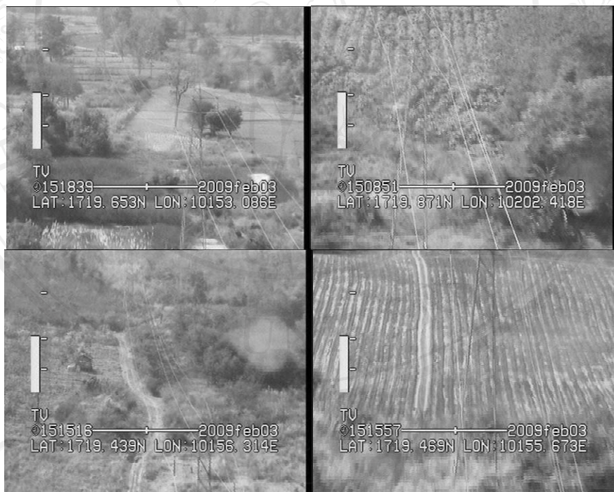
รูป 5-1 ตัวอย่างรูปที่ระบบไม่สามารถตรวจจับภาพเสาไฟฟ้าพบ
