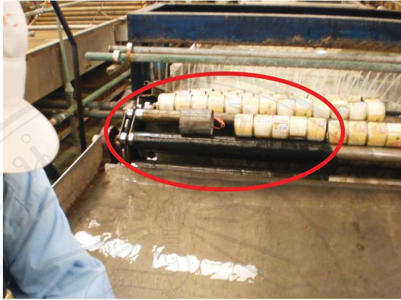
ภาพ 4.12 การแยกรหัสสินค้าโดยใช้ท่อเหล็กเป็นสัญญาณ (ก่อนการปรับปรุง)
