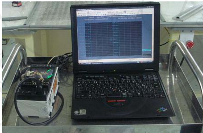
ภาพ 4.28 เครื่องมือวัดค่าอุณหภูมิในเตาอบ
