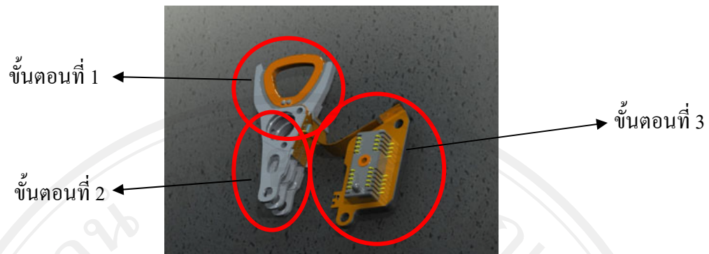
รูป 3.6 การตรวจสอบคุณภาพชิ้นงานที่ต่างกัน 3 ส่วน (ที่มา: บริษัทผู้ผลิตชิ้นส่วนฮาร์ดดิสก์ไครฟ์กรณีศึกษา)
