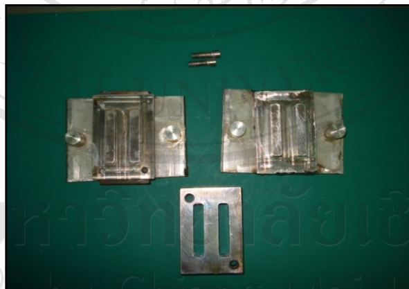
รูป 3.9 ชุดแม่พิมพ์สำหรับการอัดขึ้นรูป (Press Forming Mould)
