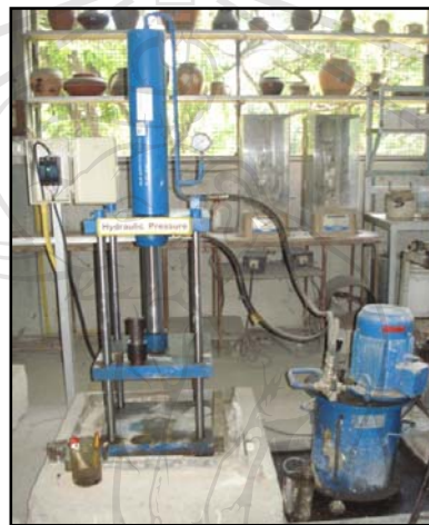
รูป 3.6 เครื่องกดอัดขึ้นรูปไฮดรอลิกเพลส (Hydraulic Press)
