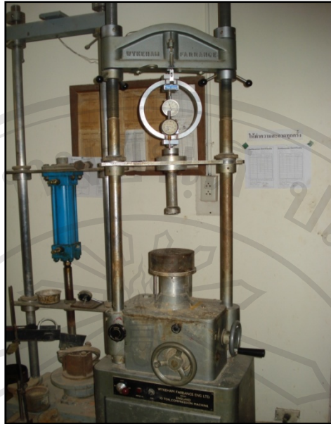
รูป 3.3 เครื่อง Universal Testing Machine สำหรับวิเคราะห์ค่าการกดอัดและค่าการดึงของชิ้นงาน
