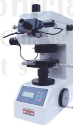
รูป 3.17 เครื่องวัดค่าความแข็งที่ใช้หัวกดแบบวิกเกอร์ส
