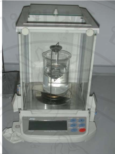
รูป 3.13 เครื่องชั่งระบบดิจิทัลสำหรับวัดค่าความหนาแน่น
