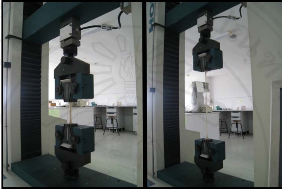
รูป 3.5 เครื่องทดสอบ tensile test รุ่น H10KS บริษัท Hounsfield test equipment ประเทศอังกฤษ
