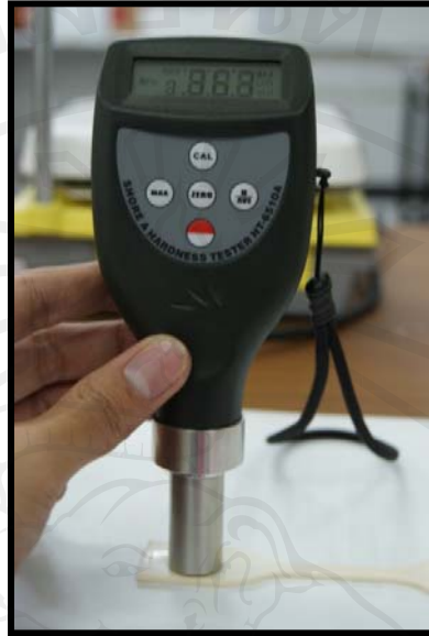
รูป 3.6 Shore type “A” Durometer รุ่น HT-6510A
