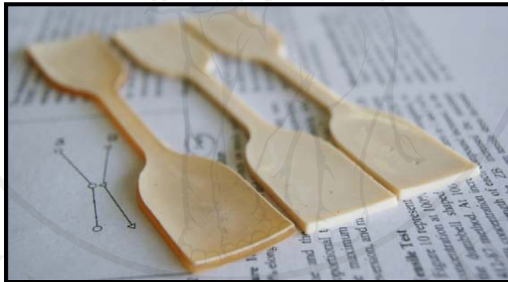
รูป 3.4 ขนาดและลักษณะของชิ้นทดสอบ
