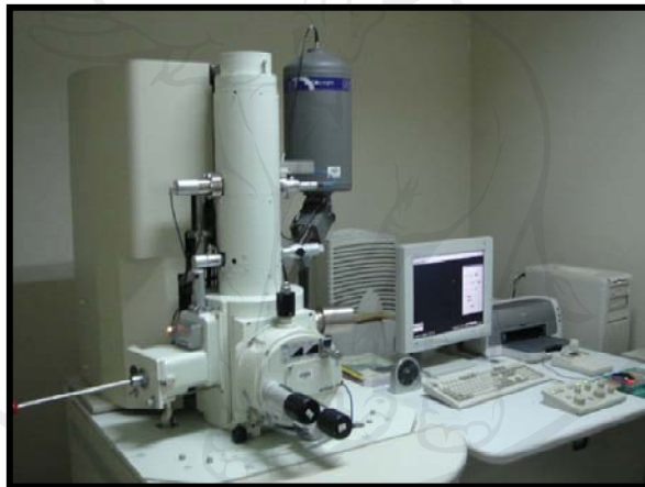
รูป 3.2 กล้องจุลทรรศน์อิเล็กตรอนแบบส่องกราด (SEM) และเครื่องวิเคราะห์การกระจายพลังงานของรังสีเอ็กซ์ (EDS)
