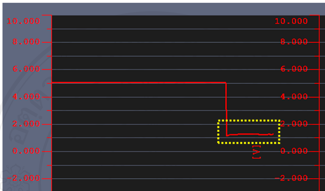
รูปที่ ก-5 ผลการวัดแรงดันไฟฟ้าที่ได้สัญญาณจากเกจวัดความดันแบบดิจิตอลหลังจากเกิดการดูดอากาศเพื่อทำสุญญากาศแล้ว
