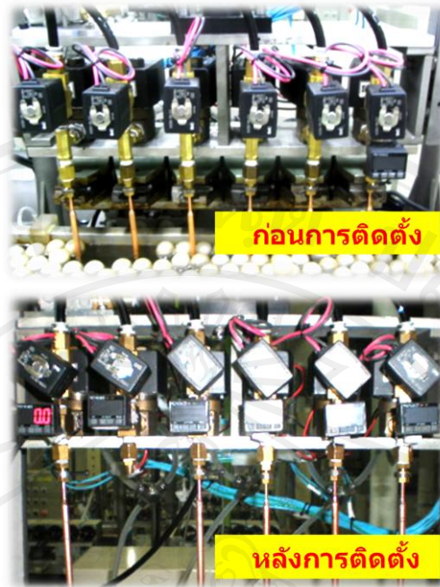
รูปที่ 3.20 การติดตั้งเกจวัดความดันแบบดิจิทัลเข้ากับเครื่องควบคุมปริมาณสารทำงานและสถานะสูญญากาศ
