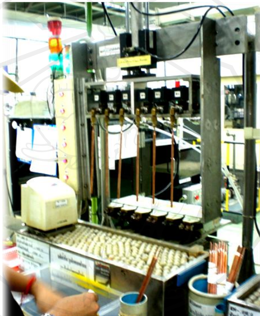
รูปที่ 3.14 เครื่องควบคุมปริมาณสารทำงานและสถานะสุญญากาศ
