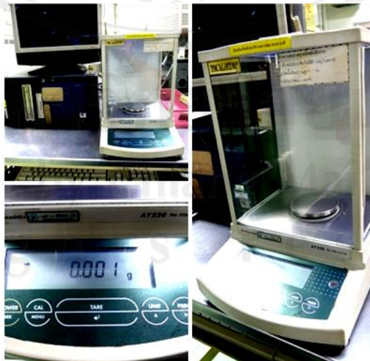
รูปที่ 3.13 เครื่องชั่งน้ำหนักแบบละเอียด ยี่ห้อ SHIMADZU รุ่น AY-220
