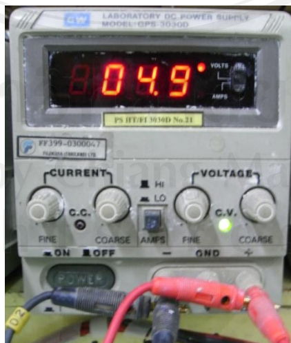
รูปที่ 3.8 แหล่งกำเนิดไฟฟ้ากระแสตรง (DC power supply) ยี่ห้อ Good Will รุ่น GPC-3030D
