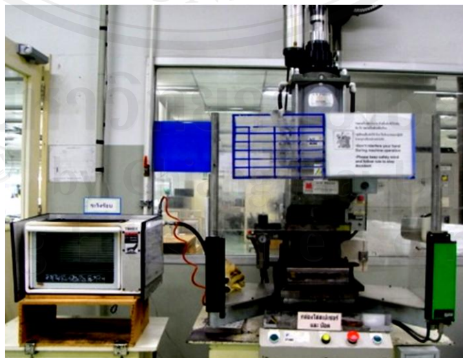
รูปที่ 3.21 เครื่องกดทับเพื่อทับแบนและควบคุมความหนาให้ชิ้นงาน
