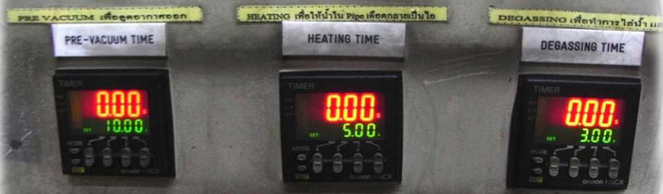
รูปที่ 4.7 การกำหนดค่าที่เครื่องตั้งเวลา (Timer) เพื่อดูดอากาศที่ 10 วินาที จุ่มและต้มในน้ำร้อนที่ 5 วินาที และ คายไอน้ำส่วนเกินที่ 3 วินาทีในกรณีที่ไม่มีการไล่ก๊าซ
