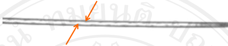
รูปที่ 4.36 ผลการ X-Ray ด้านข้างเพิ่มเติมเพื่อตรวจสอบช่องว่างไอ
