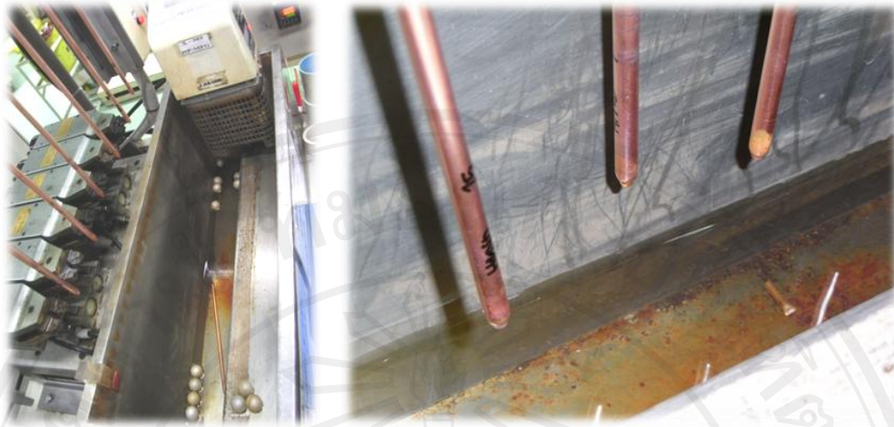
รูปที่ 4.8 ตวงน้ำร้อนออกเพื่อไม่เกิดการต้มสำหรับการควบคุมปริมาณสารทำงานสำหรับทำ ท่อความร้อนแบบไม่ไล่ก๊าซ
