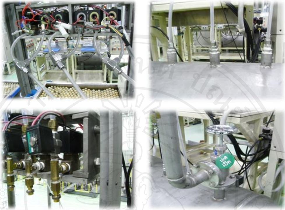
รูปที่ 4.62 ตัวอย่างของข้อต่อทั้งแบบอ่อนและแบบแข็งในระบบของเครื่องควบคุม ปริมาณสารทำงานและสถานะสุญญากาศ
