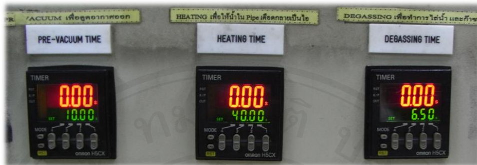
รูปที่ 4.6 การกำหนดค่าที่เครื่องตั้งเวลา (Timer) เพื่อดูดอากาศที่ 10 วินาที จุ่มและต้มในน้ำร้อนที่ 40 วินาที และ คายไอน้ำส่วนเกินที่ 6.5 วินาทีในกรณีที่มีการไล่ก๊าซ
