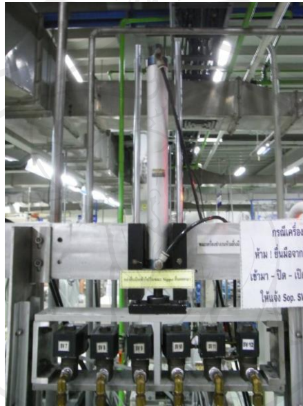
รูปที่ 4.69 กระบอกลูกสูบของเครื่องควบคุมปริมาณสารทำงานและสถานะสุญญากาศ
