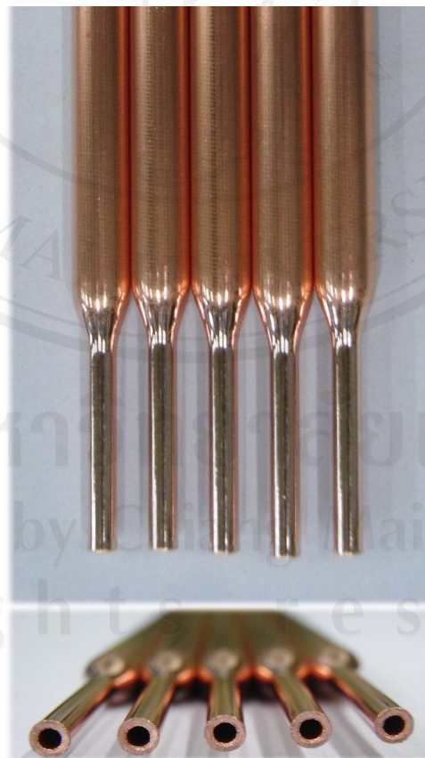
รูปที่ 4.1 ลักษณะของปลายท่อที่ลดรูป (รูปบน) และขนาดรูเติมสารทำงาน (รูปล่าง)
