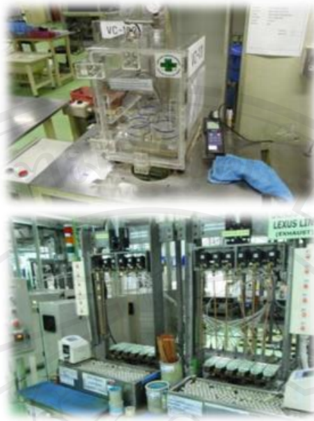
รูปที่ 4.56 เครื่องเดิมสารทำงาน (รูปบน) และเครื่องควบคุมปริมาณสารทำงานและควบคุมสภาวะสุญญากาศ (รูปล่าง)
