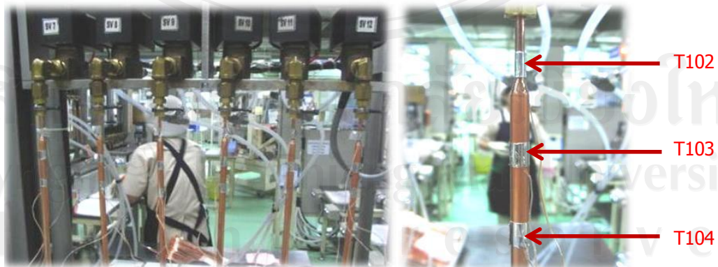
รูปที่ 4.57 การติดตั้งจุดวัดอุณหภูมิมบนท่อความร้อน โดยกำหนดให้จุด T102 อยู่บนสุดในบริเวณของท่อลด และจุด T103 อยู่ตรงกลางต่ำลงมาจากจุด T102 ประมาณ 15 มิลลิเมตร และจุด T104 อยู่ด้านล่างสุดต่ำลงมาจากจุด T103 ประมาณ 15 มิลลิเมตร
