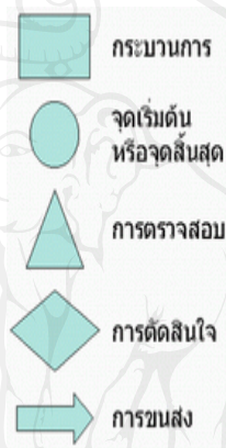
ภาพที่ 4 แสดงแสดงเส้นทางของกระบวนการ (process flow chart)
