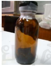
รูป 3.5 ขวดสีชาที่มีตัวอย่างนำไปปั่นแยกให้ตกตะกอน
