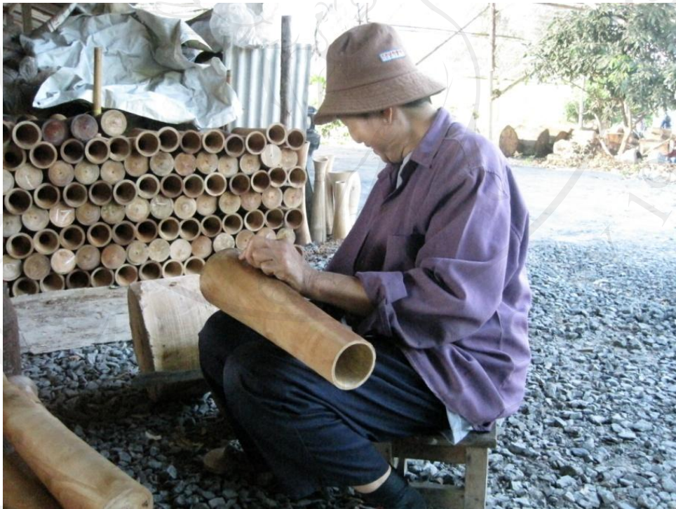
ภาพที่ 3.4 มารดานายก อบต.นครดูแลการผลิตในโรงงานในภาพเป็นการตรวจรายละเอียดชิ้นงานที่ผ่านการอบในเตาอบ ก่อนจะส่งไปทำสีและแกะลายต่อไป
