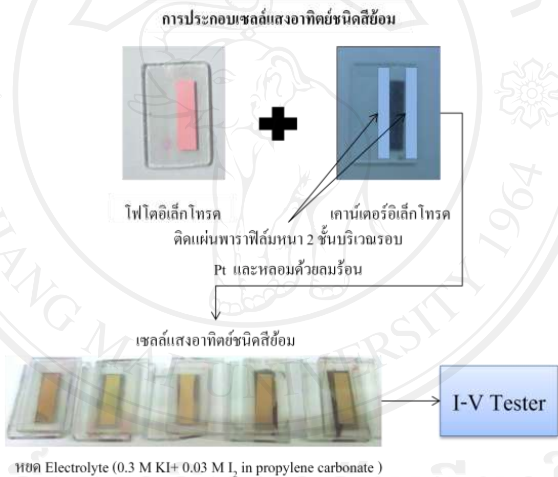
รูปที่ 3.33 แผนภาพแสดงขั้นตอนการประกอบเซลล์แสงอาทิตย์ชนิดสีส้ม
