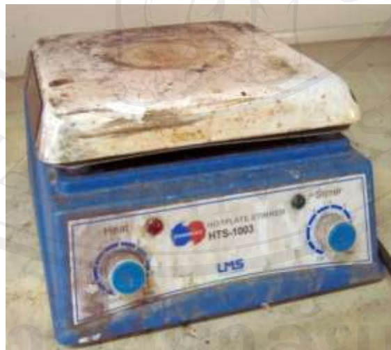
รูปที่ 3.16 แสดงเครื่องปั่น Hotplate Stirrer รุ่น HTS-100
