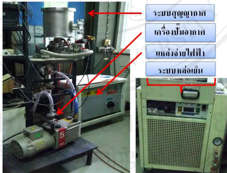
รูปที่ 3.20 แสดงส่วนประกอบหลักของเครื่องระเหยสารด้วยความร้อน (thermal evaporator)
