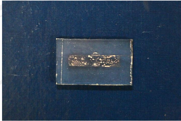
รูปที่ 3.4.2 Platinum ที่เคลือบอยู่บนกระจกนำไฟฟ้า
