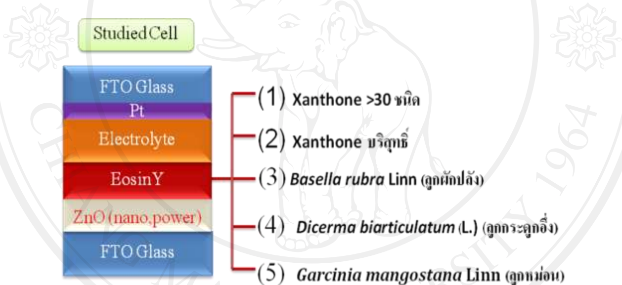
รูปที่ 3.24 แสดงโครงสร้างของเซลล์แสงอาทิตย์ที่ศึกษา
