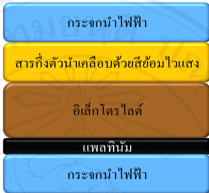
รูปที่ 1.2 แสดงโครงสร้างของเซลล์แสงอาทิตย์ชนิดสีย้อมไวแสง
