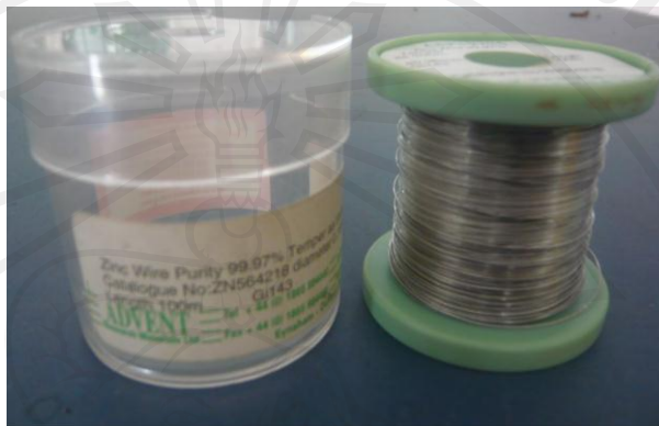
รูปที่ 3.10 แสดง Zinc wire มีความบริสุทธิ์ 99.97 % เส้นผ่านศูนย์กลาง 0.38 mm (Advent Research Materials Ltd.)
