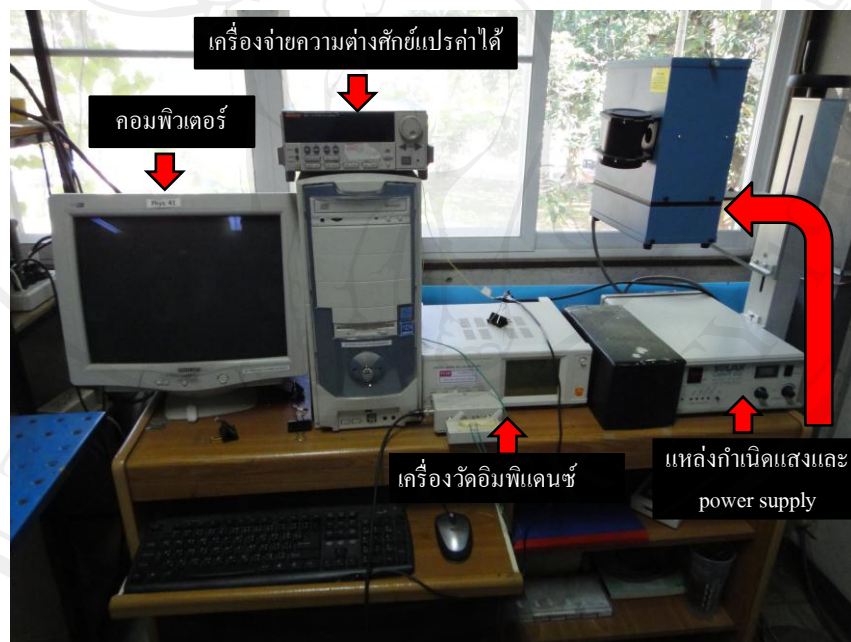
รูปที่ 3.18 แสดง ชุดทดสอบประสิทธิภาพการเปลี่ยนพลังงานแสงเป็นพลังงานไฟฟ้า [12]
