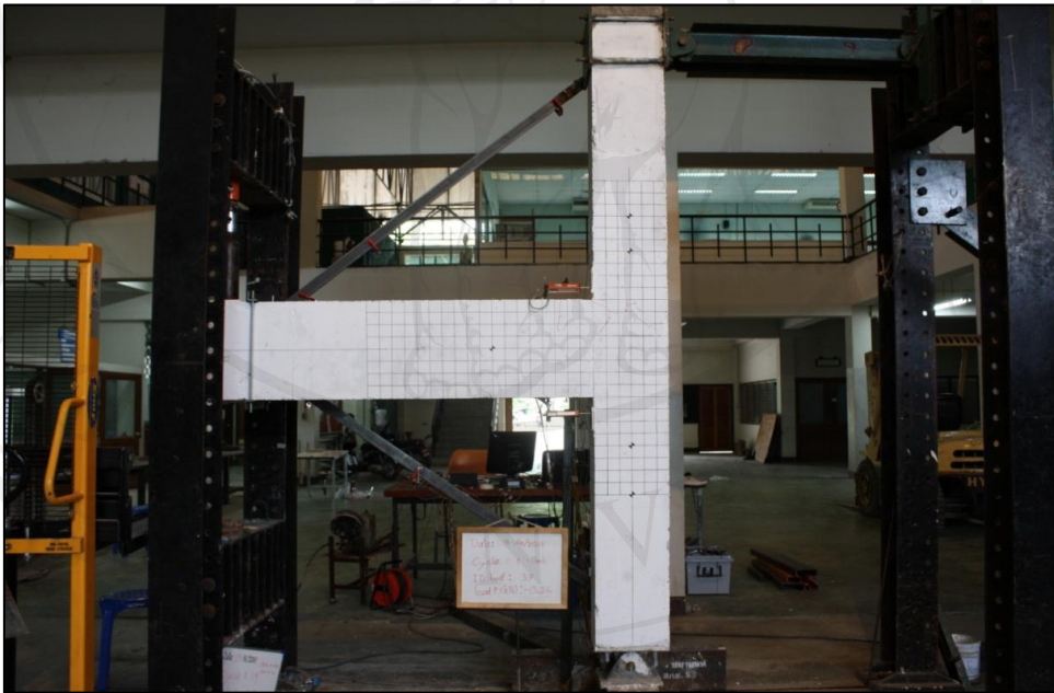
รูปที่ 3.21 ตัวอย่างทดสอบจุดต่อคอนกรีตเสริมเหล็ก (ชยานนท์, 2553)
