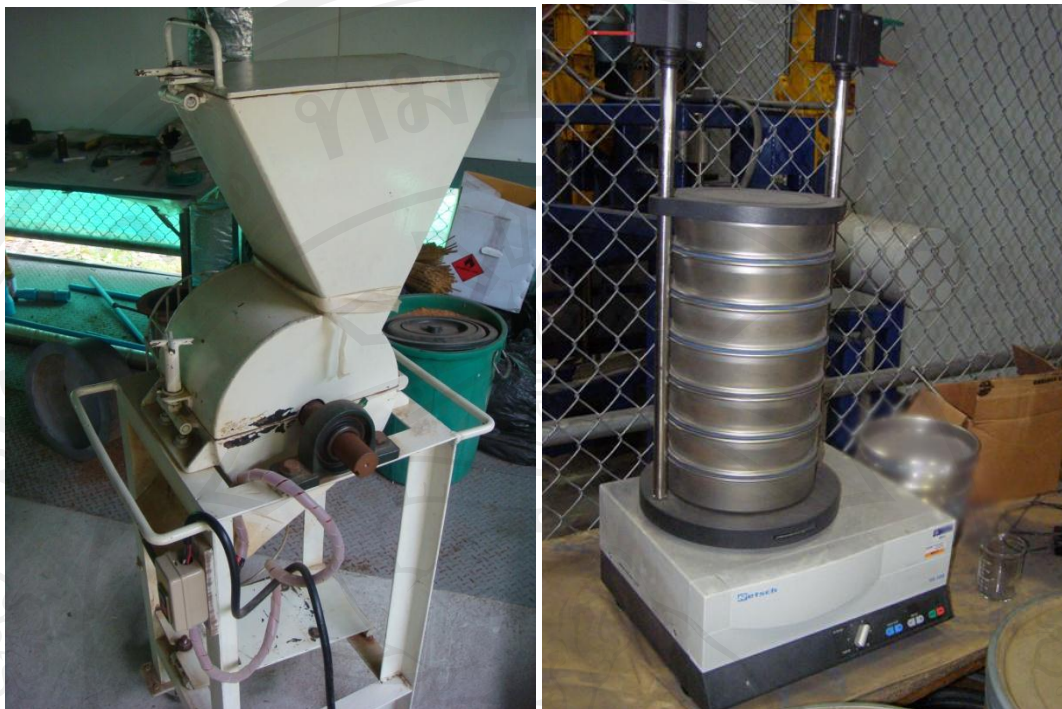
รูป 3.3 อุปกรณ์ใช้ในการเตรียมวัตถุดิบ ก) เครื่องบดหยาบ-บดละเอียด และ ข) เครื่องคัดขนาดอนุภาค
