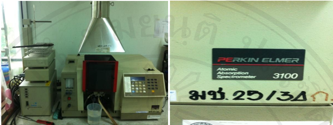
รูป 3.12 อะตอมมิกแอบซอร์พชันสเปกโทรสโกปี รุ่น perkin elmer 3100
