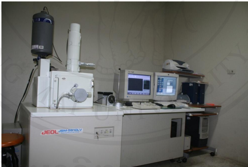
รูป 3.11 กล้องจุลทรรศน์อิเล็กตรอนแบบส่องกราด JEOL JSM-5910LV
