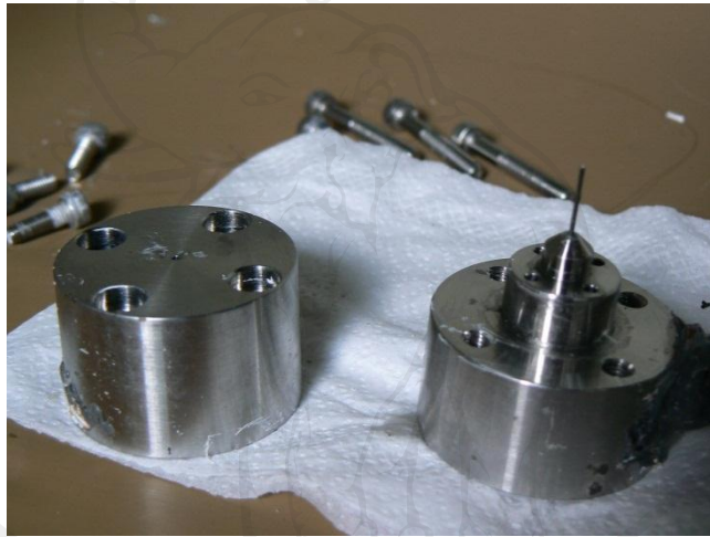
รูปที่ 0.4 หัวฉีดโพลิเมอร์ (spinneret)
