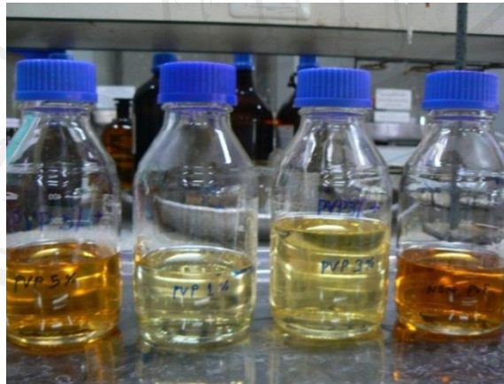
รูปที่ 0.2 สารละลายผสมที่ประกอบไปด้วย โพลิเมอร์ ตัวทำละลายและสารเติมแต่ง
