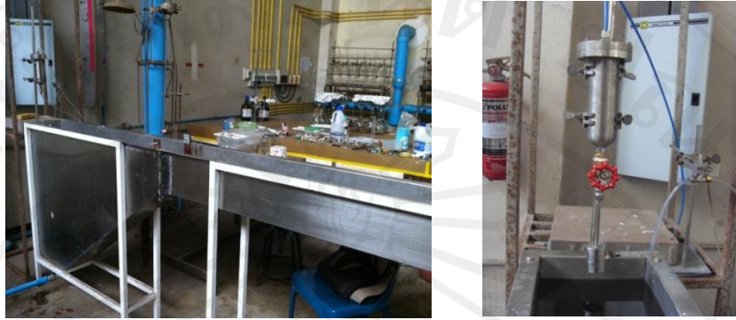
รูปที่ 0.3 ระบบการผลิตเมมเบรนแบบเส้นใยกลางในห้องปฏิบัติการ
