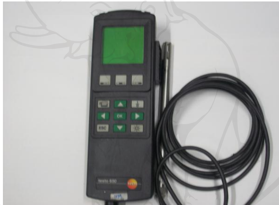
รูป ก.2 เครื่องวัดอุณหภูมิและความชื้นสัมพัทธ์อากาศแบบดิจิตอล ยี่ห้อ Testo รุ่น 650
