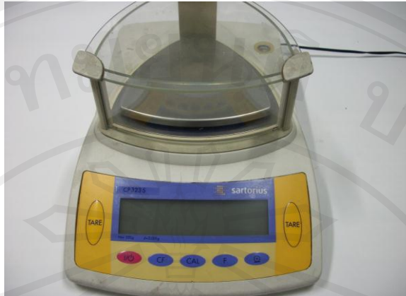
รูป ก.4 เครื่องชั่งน้ำหนักดิจิทัลความละเอียด 0.001 g ยี่ห้อ Sartorius รุ่น CP 323 S
