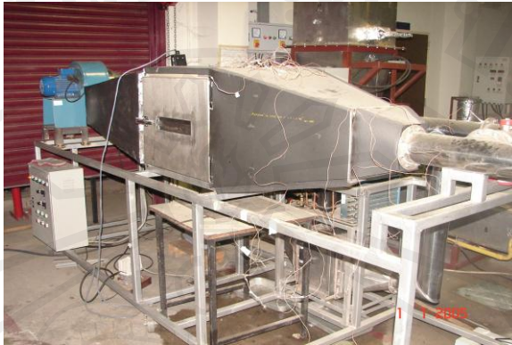
รูป 3.1 เครื่องอบแห้งที่สามารถปรับสภาวะภายในห้องอบ ที่ห้องปฏิบัติการอบแห้ง ภาควิชาวิศวกรรมเครื่องกล คณะวิศวกรรมศาสตร์ มหาวิทยาลัยเชียงใหม่
