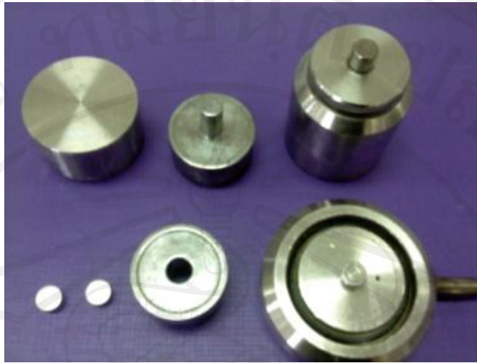
รูป 3.11 ชุดอัตรขนาดเส้นผ่านศูนย์กลาง 1 เซนติเมตร
