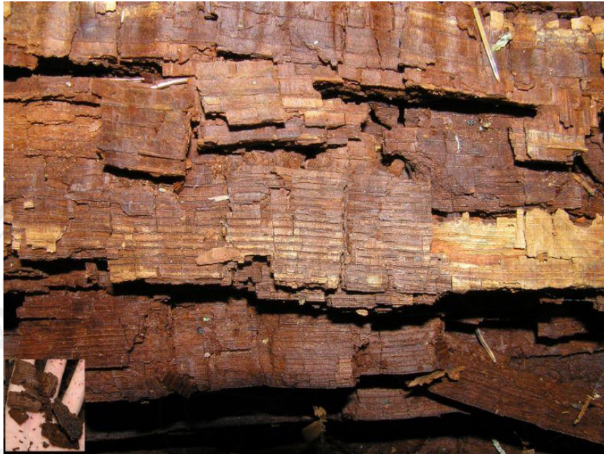
ภาพ 12 ไม้ที่ถูกย่อยสลายโดยฟังไจกลุ่ม brown rot fungi ที่มา : http://en.wikipedia.org/wiki/Wood-decay_fungus
