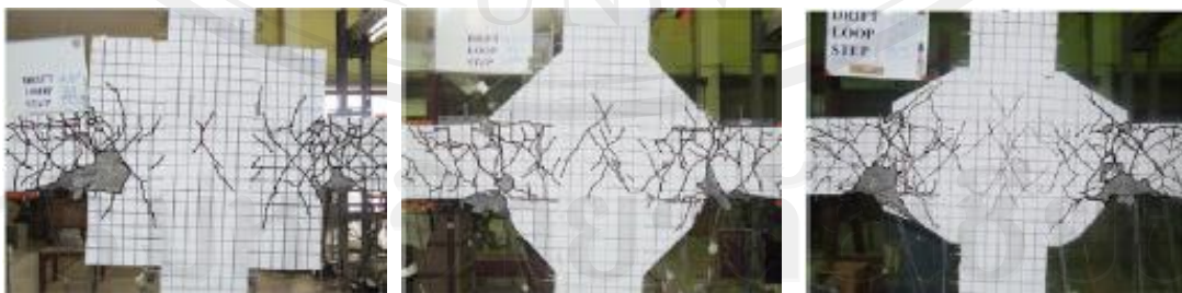
รูปที่ 1.7 รูปแบบความเสียหายของจุดต่อที่มีการเสริมกำลัง (Pimanmas and Chaimahawan, 2010)
