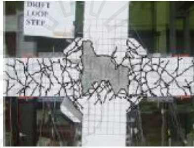
รูปที่ 1.8 การวิบัติของจุดต่อที่มีการเสริมกำลังบริเวณจุดต่อ (Pimanmas and Chaimahawan, 2010)
