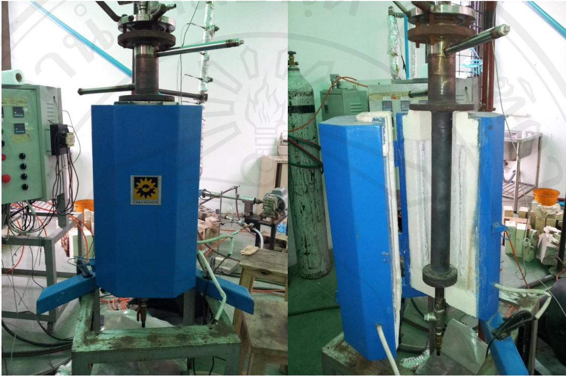
ภาพ 3.5 เต้าปฏิกิริยาที่ใช้ในกระบวนการผลิตถ่านกัมมันต์
