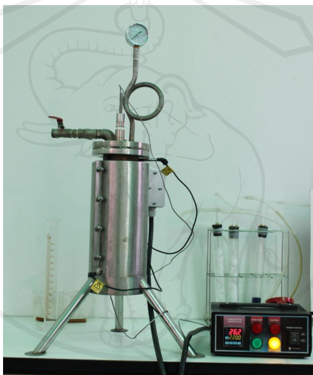
ภาพ 3.4 เตาปฏิกรณ์ที่ใช้ในกระบวนการไฮโดรเทอร์มอลคาร์บอนในเซชัน
