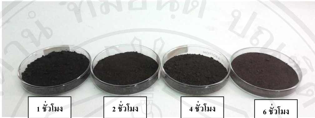
ภาพ 4.3 ถ่านชาร์ที่ได้จากกระบวนการไฮโดรเทอร์มอลคาร์บอนในเซชันกากตะกอนน้ำเสียตามระยะเวลาต่างๆ
