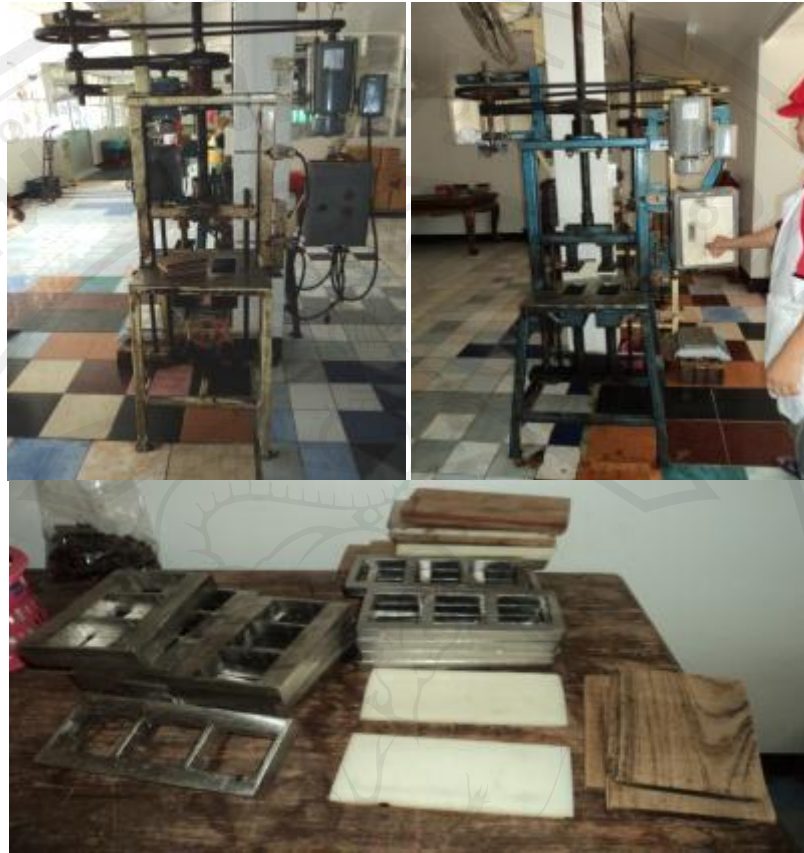
ภาพที่ 1.4 แสดงเครื่องอัดแท่งและอุปกรณ์ที่ใช้ในการอัดแท่ง
