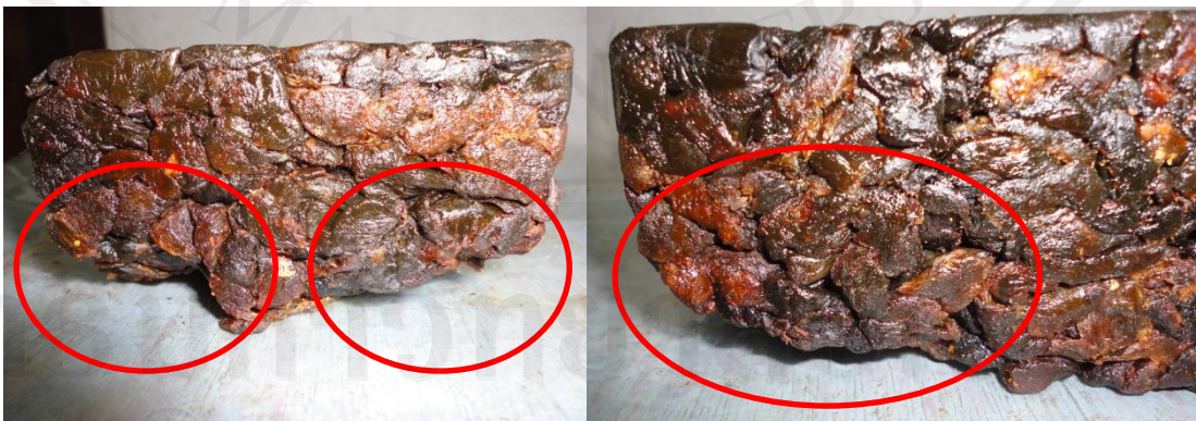
ภาพที่ 4.19 แสดงผลิตภัณฑ์ที่มีลักษณะผิดปกติที่เกิดจากกระบวนการอัดแท่งลำไย
