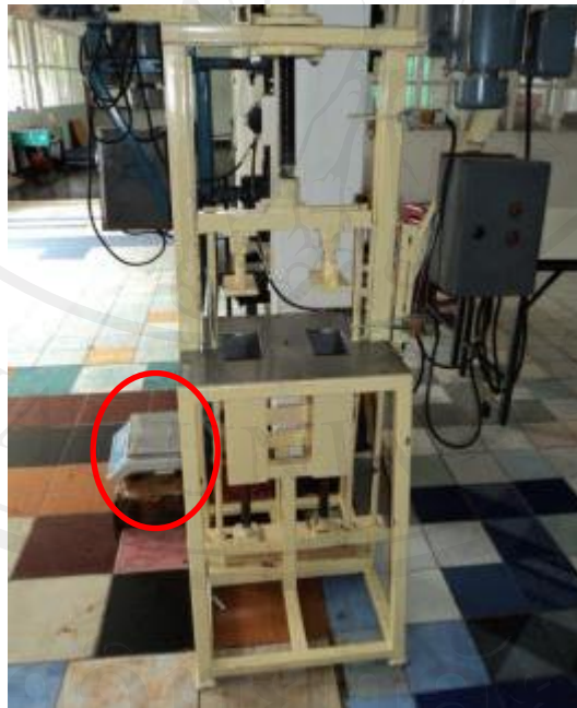
ภาพที่ 4.16 แสดงการปรับปรุงตำแหน่งของกระบวนการอัดแท่งลำไย
