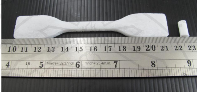
รูปที่ 3.5 ชิ้นงานสำเร็จที่ขึ้นรูปด้วยวิธีการเทหล่อ
