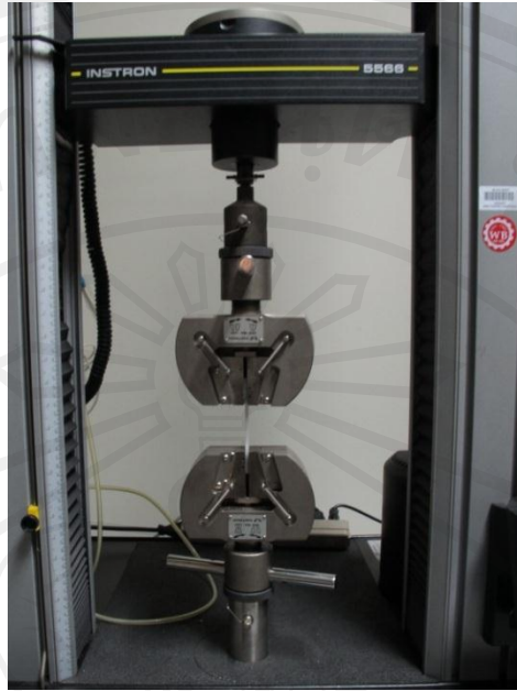
รูปที่ 3.6 ทดสอบแรงดึงชิ้นงานด้วย Universal Tester
