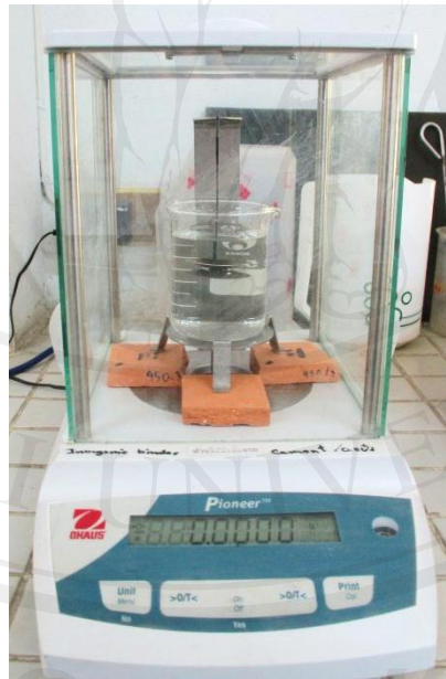
รูปที่ 3.8 Mettler Toledo Density Kit สำหรับหาความพรุน
