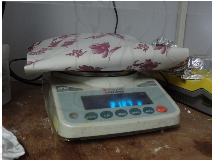
รูปที่ ค.6 : วิธีการหาความชื้น โดยแบ่งตัวอย่างของเชื้อเพลิงมาวัดน้ำหนักรวม
