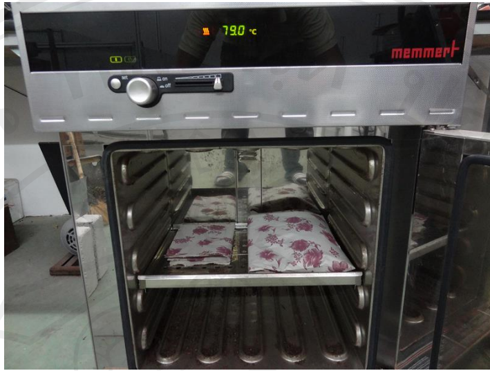
รูปที่ ค.7 : การหาน้ำหนักแห้งของตัวอย่าง โดยการนำตัวอย่างไปอบต่อจนมีน้ำหนักคงที่
