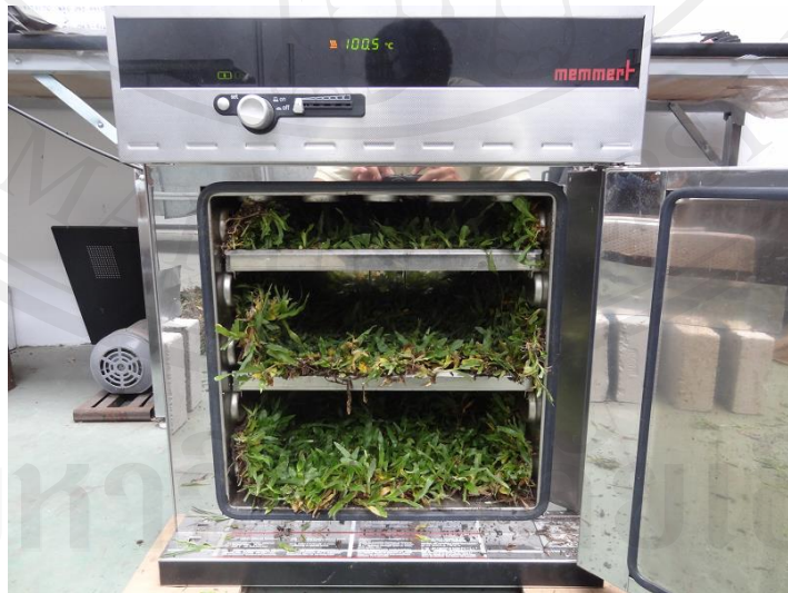
รูปที่ ค.4 : การนำเชื้อเพลิงไปอบในตู้อบที่อุณหภูมิ 135 °C เป็นเวลา 2.5 ชั่วโมง
