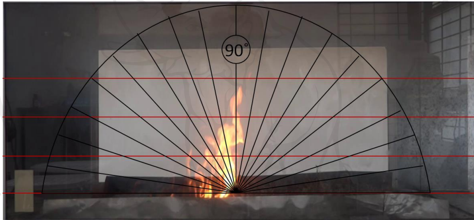
รูปที่ 20 : การวัดค่าความสูงของเปลวไฟและองศาที่เปลวไฟกระทำต่อเชื้อเพลิงของการทดลอง
