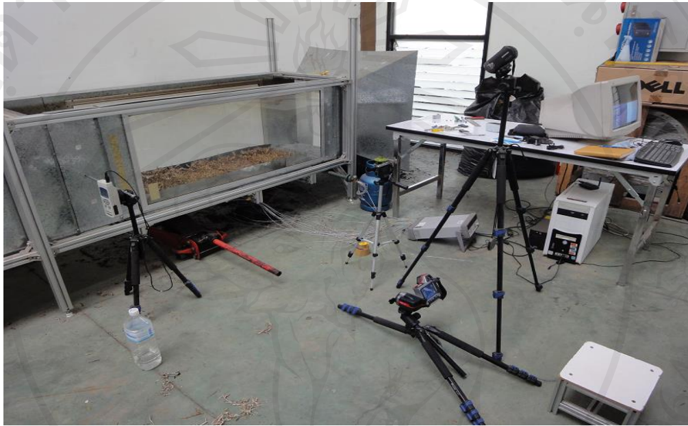
รูปที่ 16 : การเตรียมเชื้อเพลิง เครื่องมือวัดและเครื่องมือเก็บข้อมูลสำหรับการทดลอง
