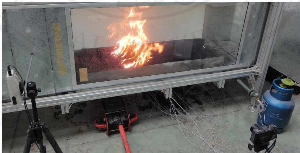
รูปที่ 17 : การทดลองของการลุกลามของไฟที่มีทิศย้อนลม
