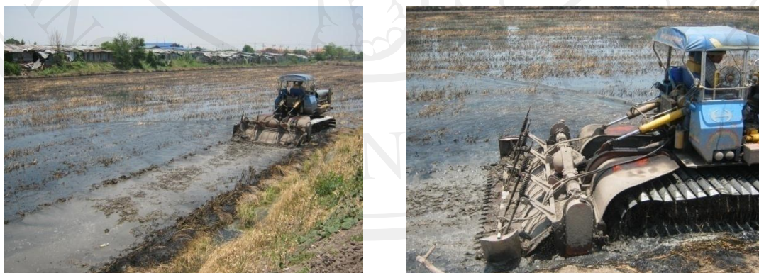
ภาพ 5.2 การไจ้รถดีดดินแทนการไจ้รถไถแบบเดินตาม
