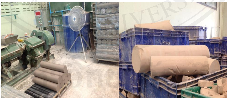
รูปที่ 4.16 แสดงการจัดวางดินที่ไม่เหมาะสมและดินขึ้นรูปที่เสื่อมสภาพไม่สามารถนำไปใช้งานได้
