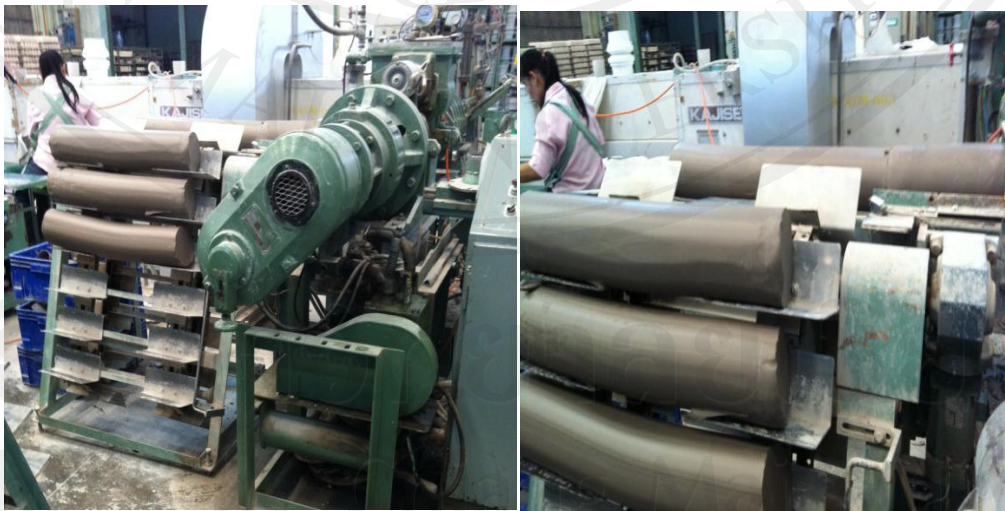
รูปที่ 4.18 แสดงการบรรจุดินเข้าเครื่องขึ้นรูปในปริมาณที่พอเหมาะสม
