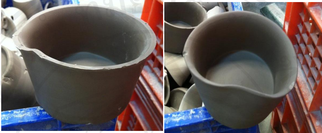
รูปที่ 4.20 แสดงลักษณะของชิ้นงานที่เสียไม่ได้รูปร่างขณะนำออกจากแม่แบบที่ยังอบไม่เสร็จ
