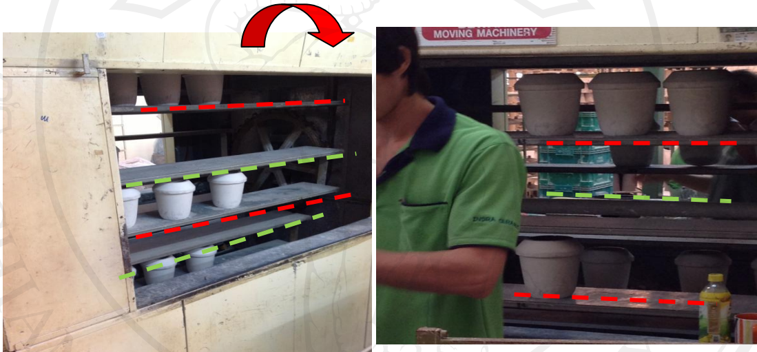
รูปที่ 4.19 แสดงตำแหน่งการทำสัญลักษณ์ขณะนำงานเข้าอบ เพื่อป้องกันความสับสนและลดการทำงานผิดพลาดของพนักงานลง
