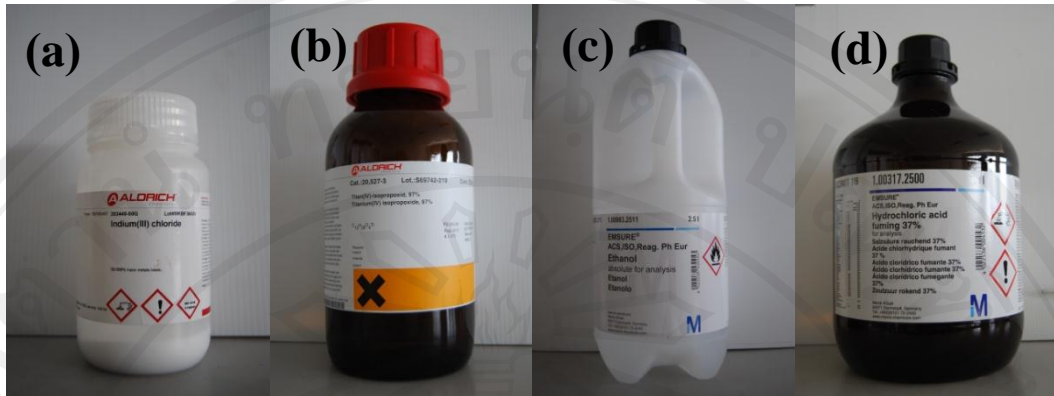
รูป 3.3 (a) ผงอินเดียมไตรคลอไรด์ ( \text{InCl}_3 ) ความบริสุทธิ์ 99.999% (b) ไทเทเนียมเตตระไฮโอไทรพอกไซด์ ( \text{C}_{12}\text{H}_{28}\text{O}_4\text{Ti} ) ความบริสุทธิ์ 97% (c) เอทานอล ( \text{CH}_3\text{CH}_2\text{OH} ) ความบริสุทธิ์ 99.99% และ (d) กรดไฮโดรคลอริก ( \text{HCl} ) ความบริสุทธิ์ 37%
