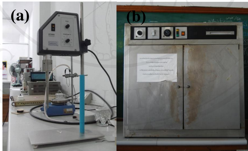
รูป 3.1 (a) เครื่องอัลตราโซนิก (ultrasonic) รุ่น UP 200S และ (b) เตาอบสารอุณหภูมิ 120^\circ\text{C}
