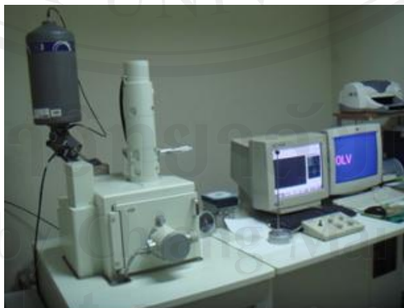
รูป 3.15 กล้องจุลทรรศน์อิเล็กตรอนแบบส่องกราด ( Scanning Electron Microscopy )
