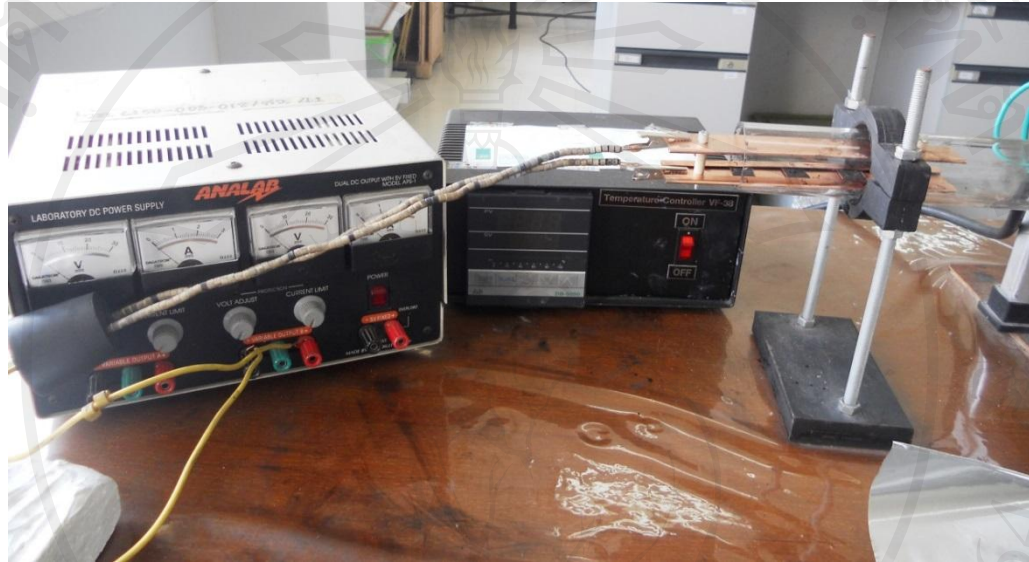
รูป 3.12 ฐานรองทองแดงที่ต่อกับแหล่งจ่ายไฟฟ้าเข้าเตาสังเคราะห์ท่อนานโนคาร์บอน
