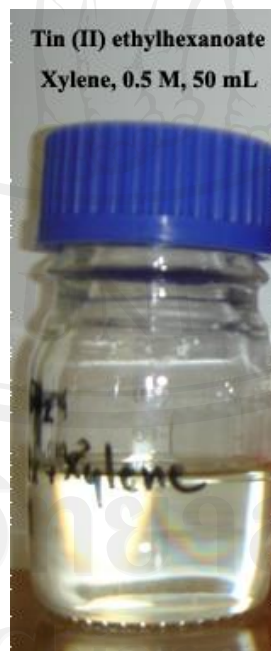
รูป 3.5 สารละลายตั้งต้นชนิด Tin (II) 2-ethylethanoate ละลายใน ตัวทำละลาย Xylene ในขวดที่ใช้เตรียมสารละลายตั้งต้น
