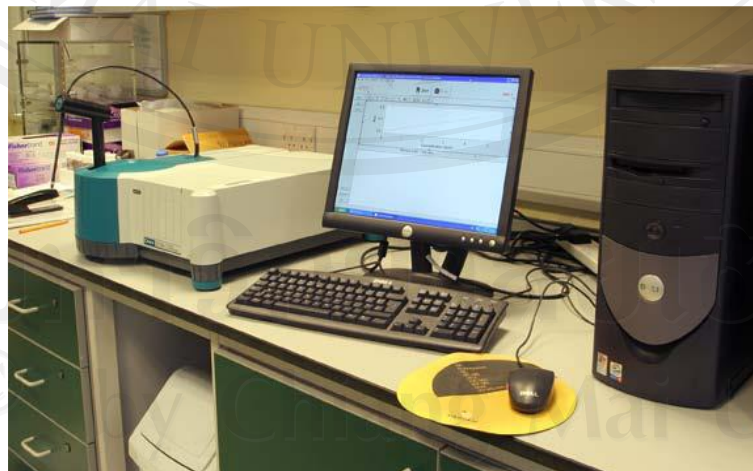
รูป 3.11 เครื่อง UV-Visible Spectrophotometer VARIAN รุ่น Cary 50 Conc
