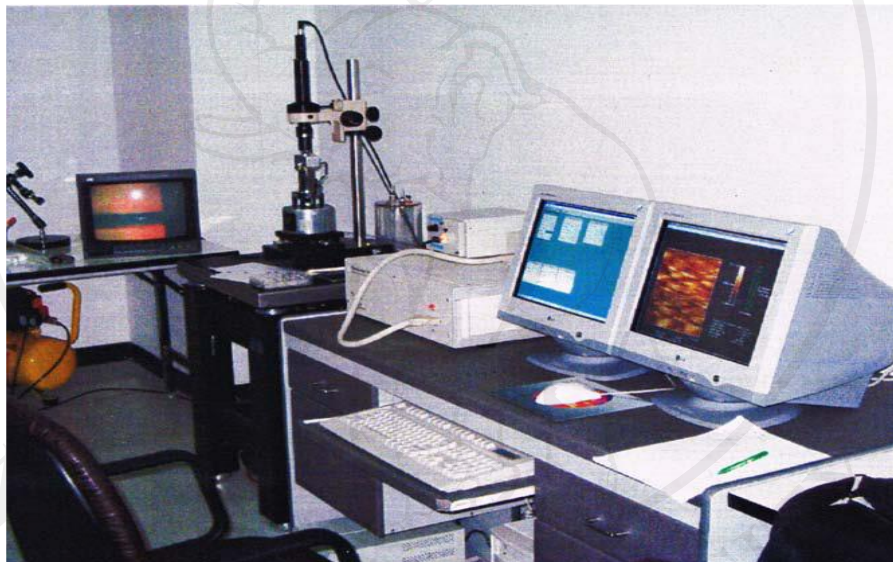
รูป 3.10 กล้องจุลทรรศน์แรงอะตอม (AFM) Veeco Digital Instruments รุ่น Nano Scope ® IIIa
