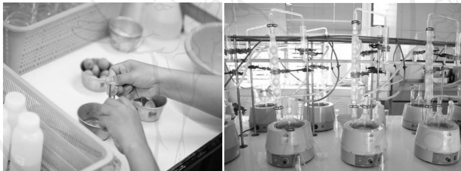
ภาพ 3 การเตรียมตัวอย่าง (ซ้าย) และการวิเคราะห์ซัลเฟอร์ไดออกไซด์ (ขวา) ตามวิธีของ modified Monier – William method (AOAC, 1995)
