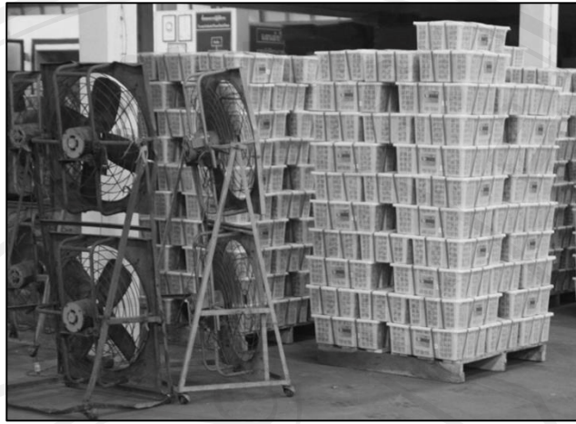
ภาพ 17 การใช้พัดลมเพื่อช่วยในการระบายและลดปริมาณก๊าซซัลเฟอร์ไดออกไซด์นอกห้องรม
