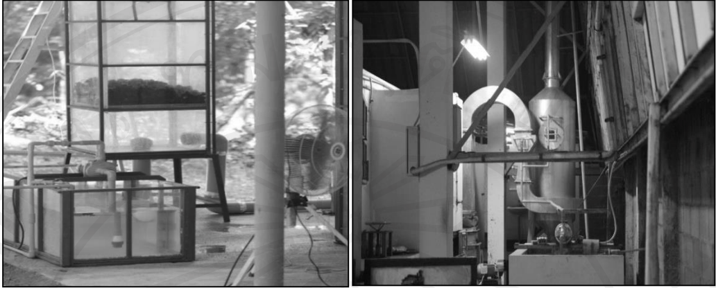
ภาพ 15 หอกำจัดก๊าซซัลเฟอร์ไดออกไซด์ก่อนปล่อยสู่บรรยากาศ
