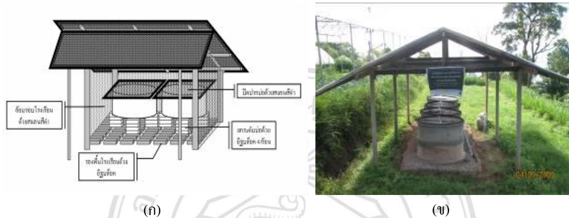
ภาพที่ 2.4 โรงเรือนในพื้นที่ที่ความสูงมากกว่า 500 - 1,000 เมตรจากระดับน้ำทะเลปานกลาง
