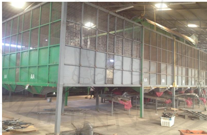
รูปที่ 20 ถังพักขนาดใหญ่คัดเกรดลำไย แหล่งที่มา: เก็บข้อมูลภาคสนาม 21 พฤษภาคม 2556
