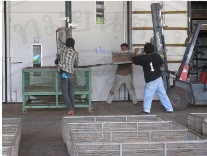
รูปที่ 18 การเทลำไยอบแห้งลงบนกระบะลำเลียง แหล่งที่มา: เก็บข้อมูลภาคสนาม 10 พฤษภาคม 2556
