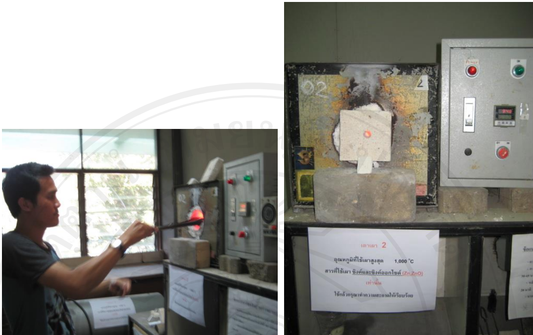
ภาพที่ 3.15 เตาเผาแบบท่อ สำหรับสังเคราะห์ ชิงก์ออกไซด์เตตระพอด
