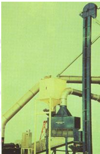
ภาพที่ 2.7 เครื่องลดความชื้นแบบฟลูอิดไดซ์-เบด ที่มา : สุรเวทย์ กฤษณะเศรษฐี และเปรมจิตต์ สระวาสี, 2550
